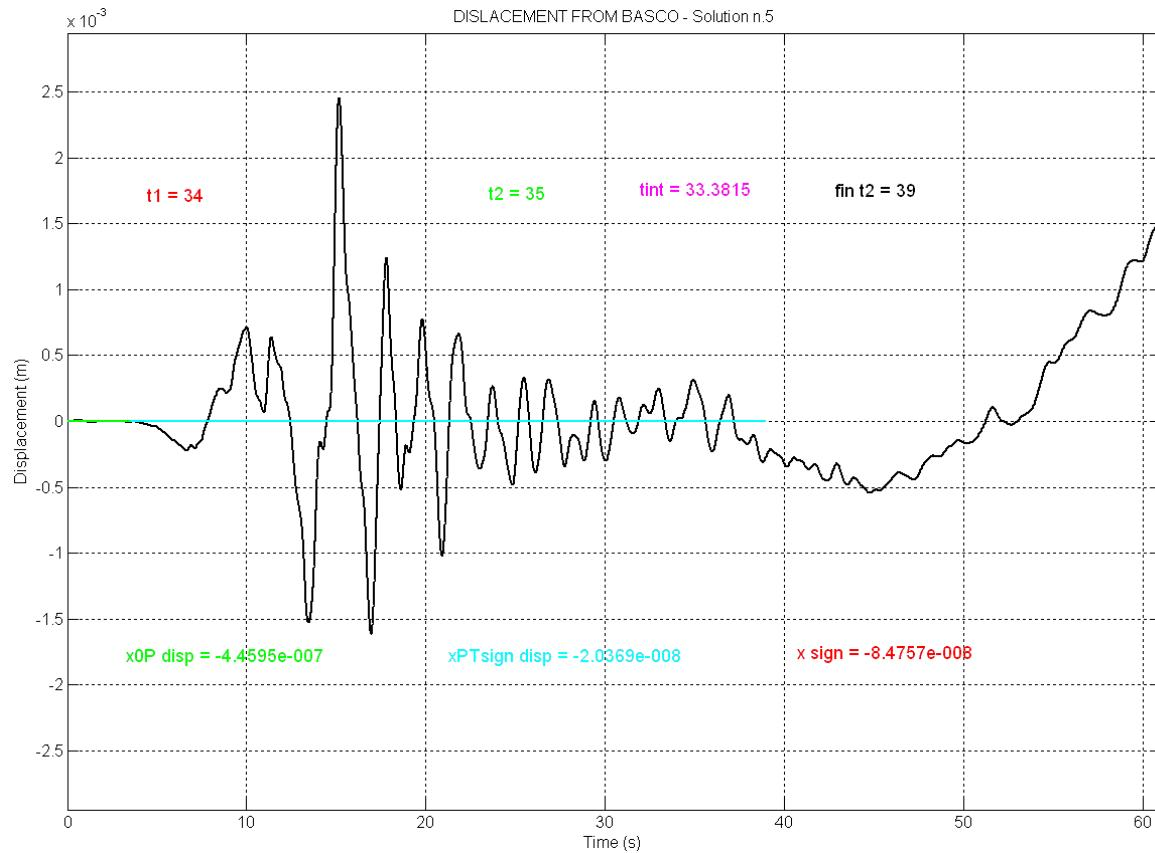
Come emerge dalla figura, per quanto si riesca ad ottimizzare la correzione per un tratto sufficientemente lungo del segnale, ne permane una porzione che si discosta troppo dalla linea dello zero, per cui si deve prevedere l'eventualità di limitare la durata del segnale in spostamento (circa 35 secondi per il caso mostrato in figura).
